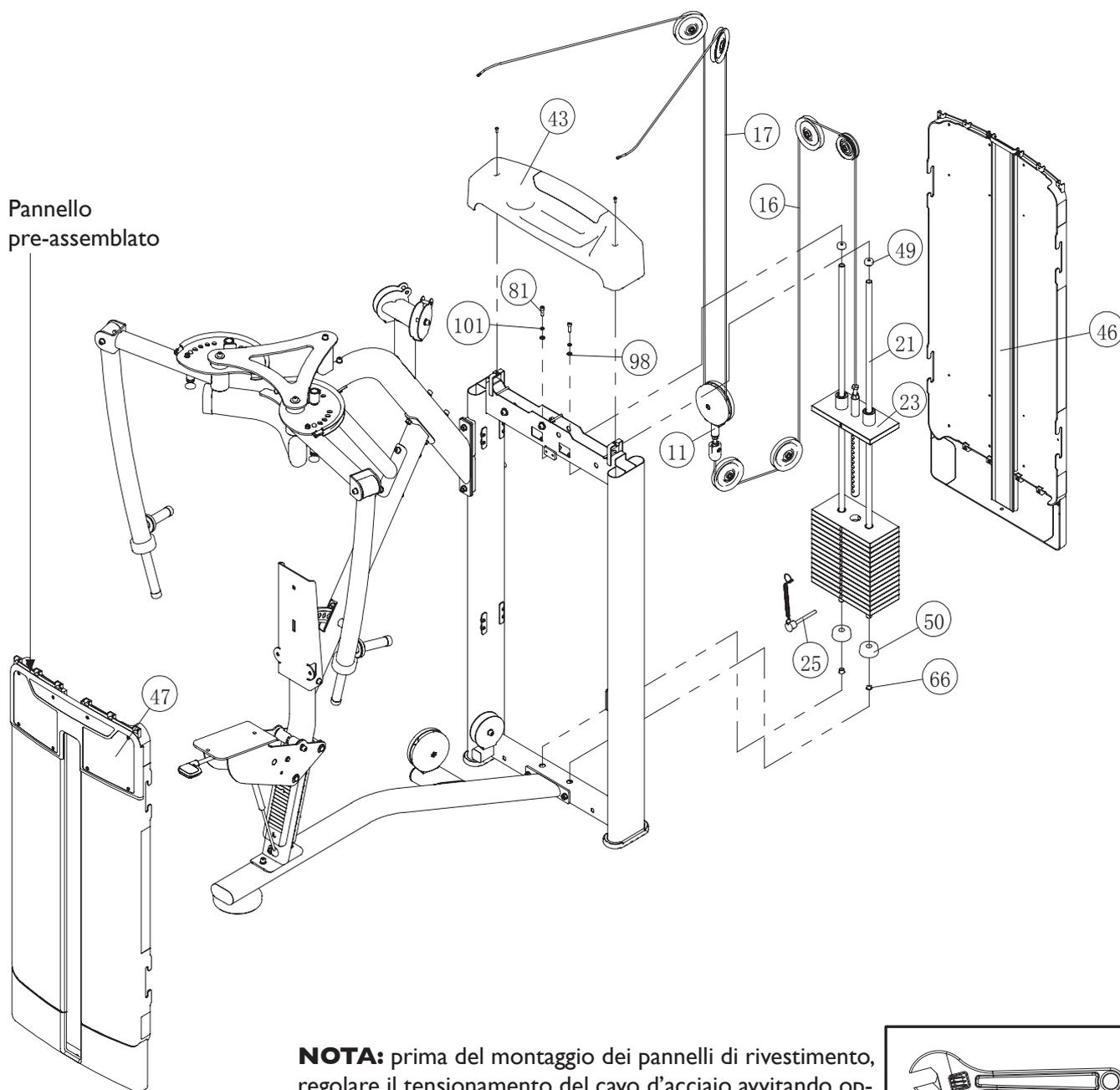
**NOTA:** prima del montaggio dei pannelli di rivestimento, regolare il tensionamento del cavo d'acciaio avvitando opportunamente il bullone sull'asta di selezione pesi.
